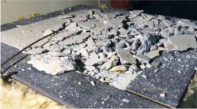
**Bild 8:** Oberfläche des Probekörpers FB 6 nach dem Abplatzen
