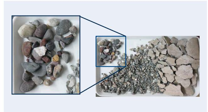
**Bild 9:** Abgeplatzte Betonbruchstücke (FB 6); Gesteinskörnung frei von Zementstein (links)
