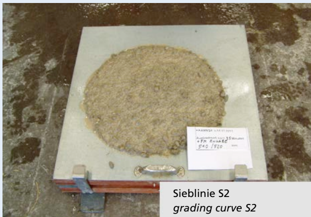
Bild 4: Einfluss der Gesteinskörnungszusammensetzung, insbesondere der Korngruppe 0/0,125, auf die Wasser- und Zementleimrandbildung des Betons im Ausbreitversuch Figure 4: Influence of the aggregate particle size composition, in particular of the 0/0.125 size group, on the formation of water and cement paste borders around the concrete in the flow table test
