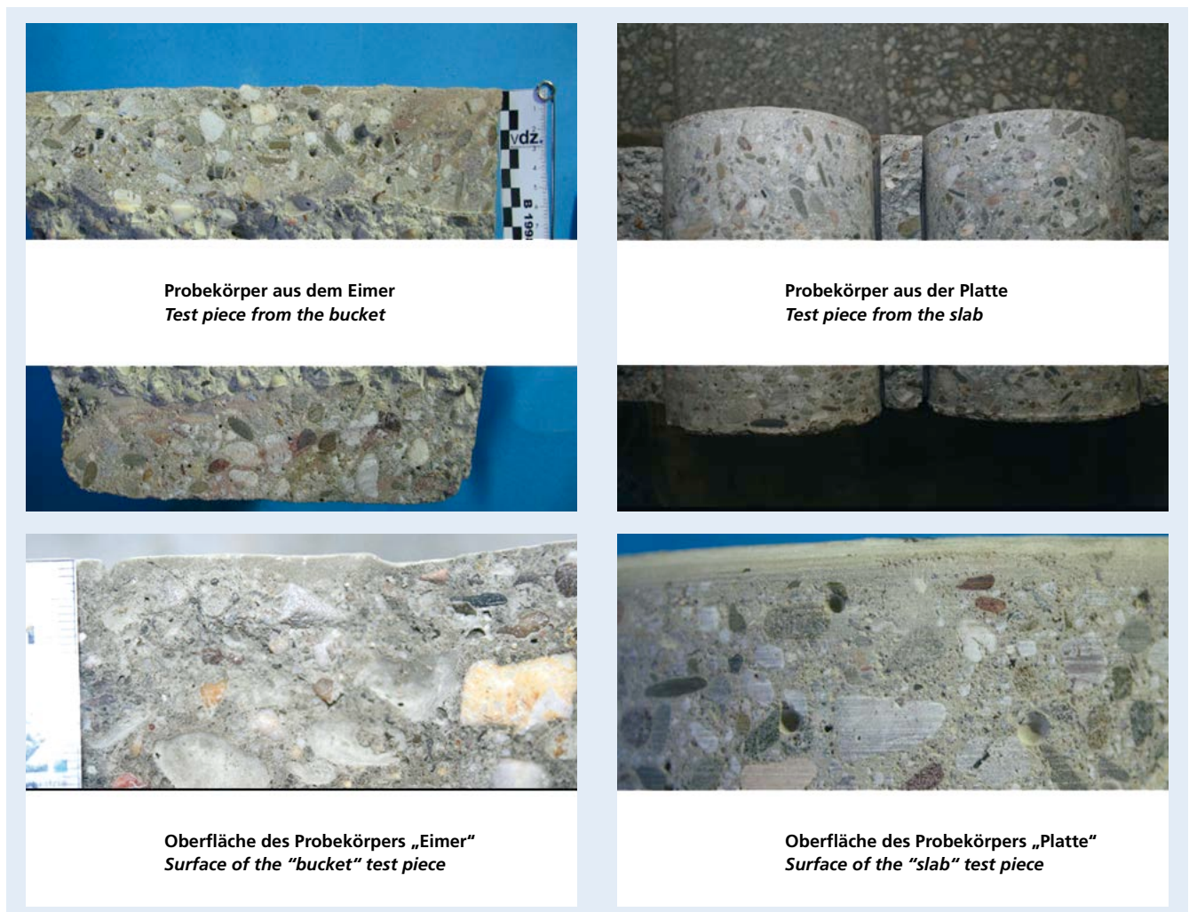
Bild 12: Feinmörtelanreicherung an Prüfkörpern aus dem Eimerverfahren (links) und Zementleimanreicherung an Prüfkörpern aus der Betonplatte (rechts); c = 340 \text{ kg/m}^3 ; w/z = 0,50 ; CEM II/B-S 42,5 N; Sieblinie S4; 2,4 M.-% v. z MNS Figure 12: Accumulation of fine mortar in test pieces from the bucket method (left) and accumulation of cement paste in test pieces from the concrete slab (right); c = 340 \text{ kg/m}^3 ; w/c = 5.0 ; CEM II/B-S 42,5 N; grading curve S4; 2.4 mass % MNS w.r.t.c
