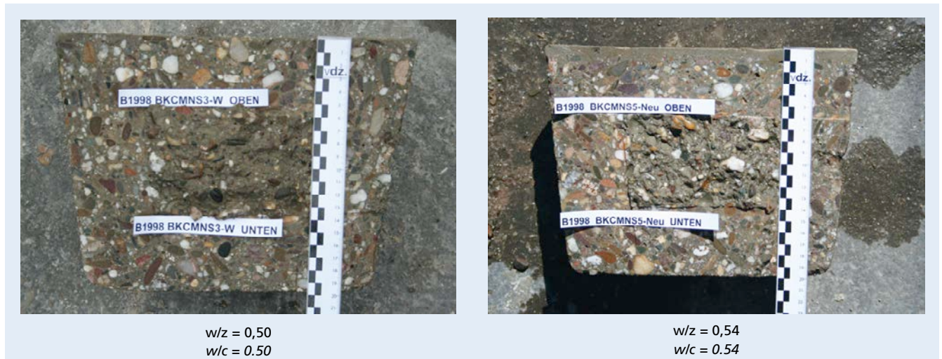
Bild 9: Prüfkörper zur Beurteilung der Stabilität im erhärteten Zustand und zur Bestimmung der Porosität im Alter von 28 Tagen. z = 340 \text{ kg/m}^3 ; Zement CEM II/A-LL 32,5 R; MNS: 1,4 M.-% v.z.; Sieblinie S1
