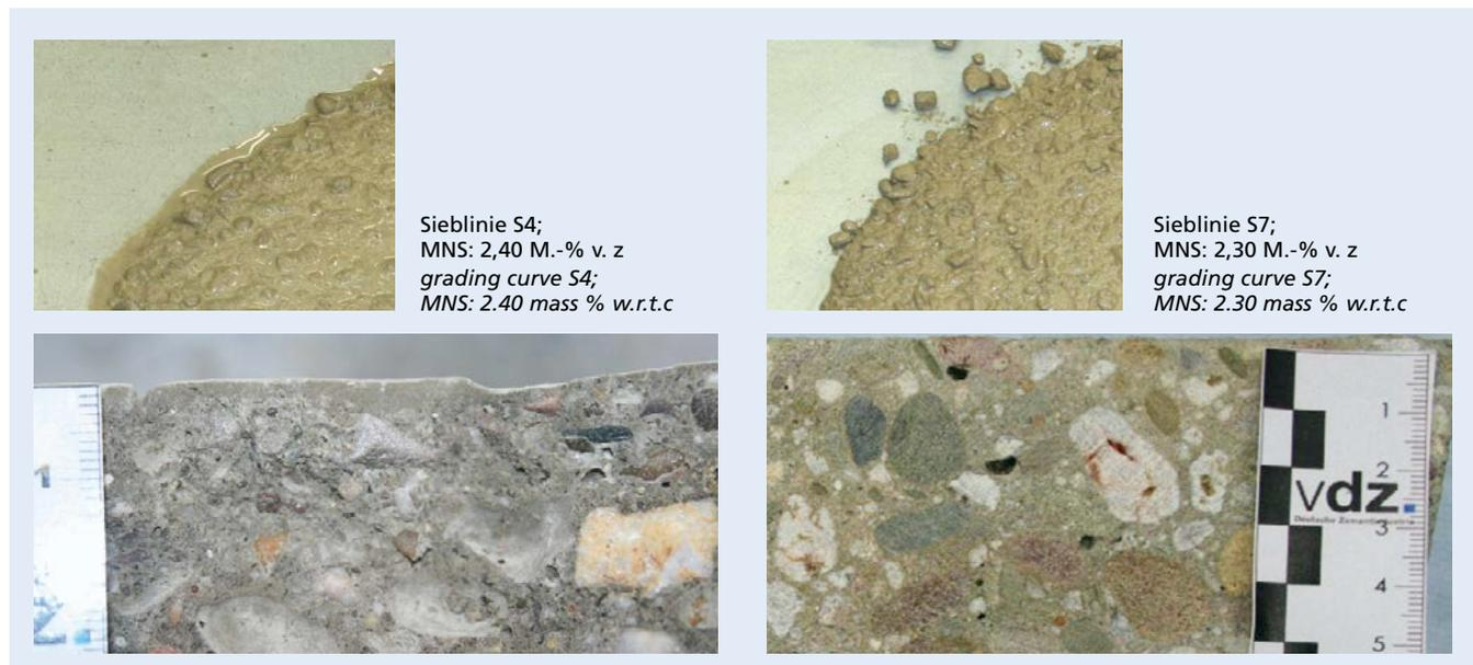
**Bild 11:** Einfluss der Kornzusammensetzung der Sieblinie auf die Stabilität des Frischbetons und die Feinstörtelverteilung im Festbeton.
