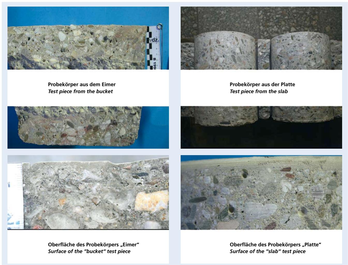
**Bild 12:** Feinmörtelanreicherung an Prüfkörpern aus dem Eimerverfahren (links) und Zementleimanreicherung an Prüfkörpern aus der Betonplatte (rechts);  $c = 340 \text{ kg/m}^3$ ;  $w/z = 0,50$ ; CEM II/B-S 42,5 N; Sieblinie S4; 2,4 M.-% v. z MNS
