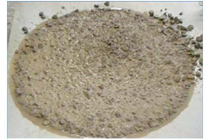
**Bild 2: Entmischungserscheinungen bei einem Beton mit einem Leimgehalt von ca. 260 l/m<sup>3</sup> (siehe Kennzeichnung in Bild 1)**
