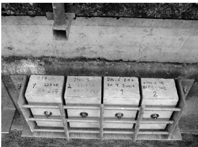
Bild 18: Auslagerungsstelle für die Betone B4 (w/z = 0,50 und z = 320 kg/m 3 ) an der Schleuse Hilpoltstein [16] bei hoher Wassersättigung ohne Taumittel Figure 18: Outdoor exposure site for the B4 concretes (w/c = 0.50 and c = 320 kg/m 3 ) at the Hilpoltstein lock [16] with high water saturation without de-icing agent
