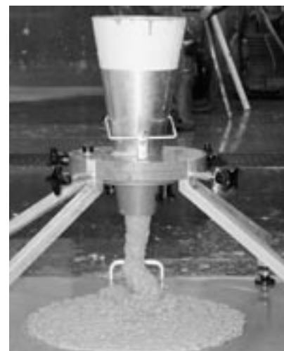
Bild 10: Ermittlung der Auslaufzeit und des Setzfließmaßes für SVB 6 mit dem Auslaufkegel und montierter 60-mm-Auslaufdüse Figure 10: Determination of the flow time and the slump flow for SCC 6 with the flow cone using the 60 mm outlet nozzle
