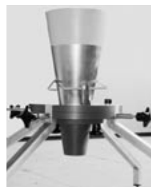
Bild 7: Montierter Auslaufkegel mit 50-mm-Auslaufdüse Figure 7: Assembled flow cone with 50 mm outlet nozzle
