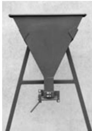
Bild 3: Auslauftrichter für SVB zur Bestimmung der Trichterauslaufzeit T ( b_{oben} = 515 mm, b_{unten} = 65 mm, h_{ges} = 600 mm, Neigung = 45°) Figure 3: Flow-funnel for SCC for determining the V-funnel flow time T ( b_{top} = 515 mm, b_{bottom} = 65 mm, h_{total} = 600 mm, slope = 45°)
