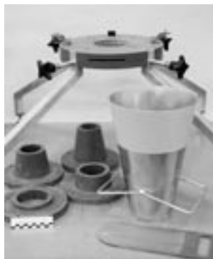
Bild 6: Bestandteile des Auslaufkegels: Setztrichter, Setztrichterhalterung, Auslaufdüsen und Schieber Figure 6: Components of the flow cone: slump cone, slump cone support stand, outlet nozzles and slide
