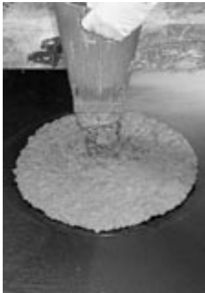
Bild 2: Durchführung der Setzfließmaßprüfung mit umgedrehtem Setztrichter auf Setzfließplatte (900 x 900 mm) mit 500-mm-Markierung für die Bestimmung der Fließzeit Figure 2: Carrying out the slump flow test with the inverted slump cone on the slump flow plate (900 x 900 mm) with 500 mm mark for determining the flow time
