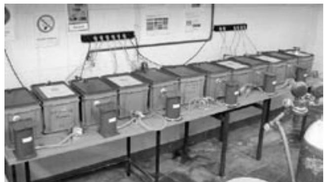
Bild 2: pHstat-Versuchsaufbau mit Säure/Base-Puffersystem
