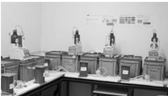
Bild 1: pHstat-Versuchsaufbau mit kontinuierlicher Endpunkttitration
