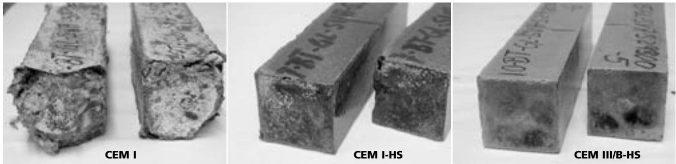
Bild 10: Betonprismen mit calciumcarbonathaltiger Gesteinskörnung ( w/z = 0,50 ) nach 400 Tagen Lagerung in Natriumsulfatlösung (29 800 mg Sulfat/l), Lagerungstemperatur 8 °C
