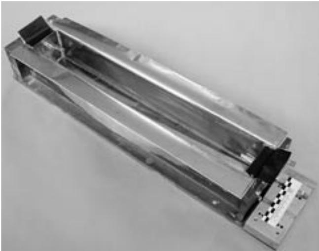
**Bild 1: Versuchseinrichtung zur Ermittlung des autogenen Schwindens**
