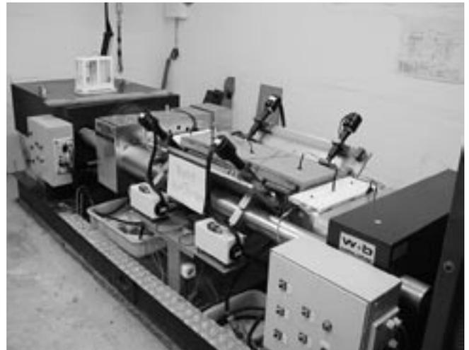
Bild 3: Temperatur-Spannungsprüfmaschine
