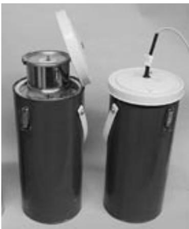
**Bild 2: Hydratationswärmebestimmung**
