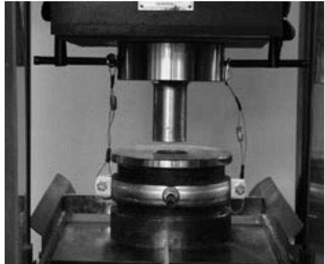
**Bild 2: Auspressvorrichtung**
