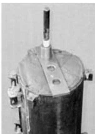
**Bild 6: Tauchstabversuch: Tauchstab ist vollständig bis zur Markierung durch Führungsrohr in mit SVB gefülltem Probekörper (Zylinder  $\varnothing = 150$  mm,  $h = 600$  mm) abgesunken**
