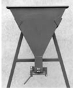
**Bild 3:** Auslauftrichter für SVB zur Bestimmung der Trichterauslaufzeit T
