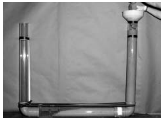
Bild 10: Fließen des Selbstverdichtenden Betons im Acrylglasrohr Ø 100 mm Fig. 10: Flow of the self compacting concrete in the 100 mm diameter acrylic glass tube
