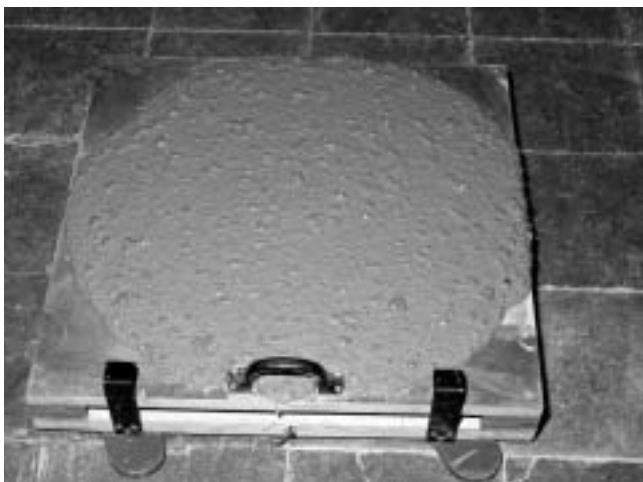
Bild 9: Ausbreitmaß des SVB (rd. 70 cm ohne Schlag) Fig. 9: Flow diameter of the SCC (about 70 cm without impact)
