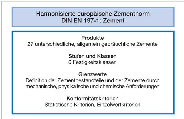
Bild 2: Harmonisierte europäische Zementnorm DIN EN 197-1 Regelungsinhalte
