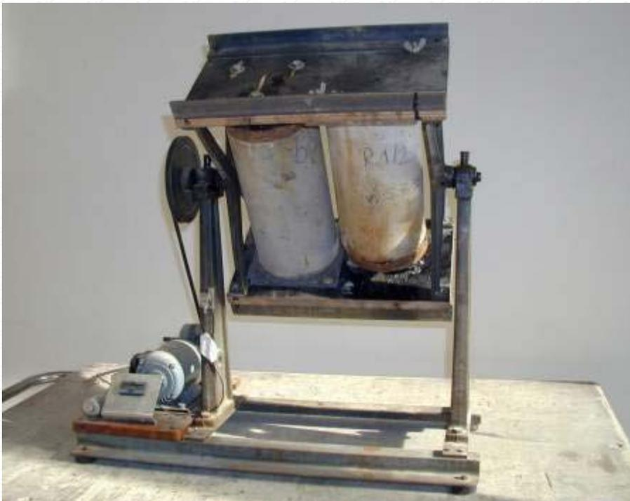
**Bild 6:** Prüfapparatur zur Simulation der Kanalbedingungen mit abrasiver Beanspruchung
