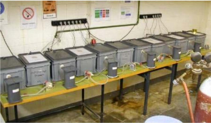
**Bild 2:** pHstat-Versuchsaufbau mit Säure/Base Puffersystem
