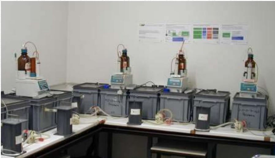
**Bild 1:** pHstat-Versuchsaufbau mit kontinuierlicher Endpunkttitration
