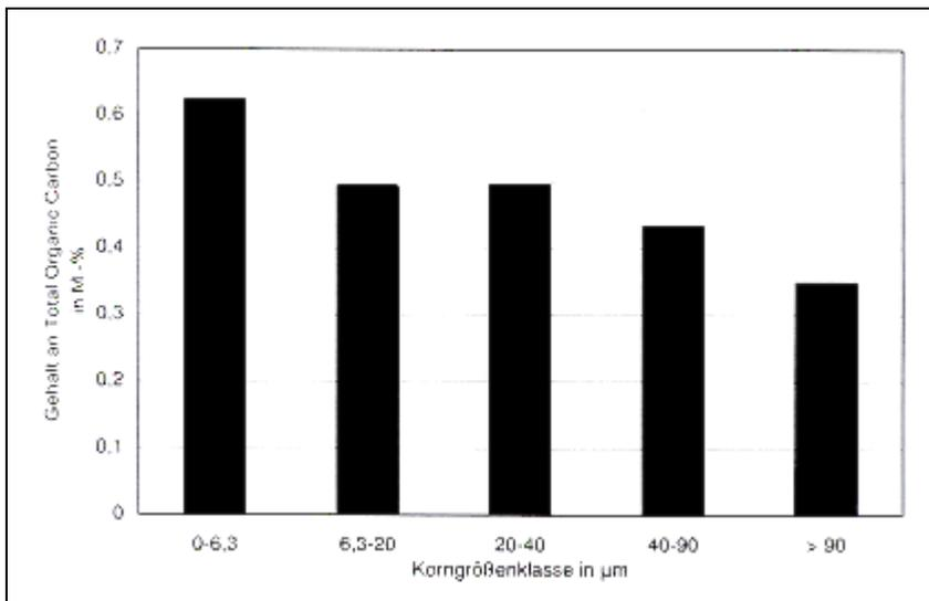
Bild 3: TOC-Gehalt in unterschiedlichen Korngrößenklassen eines Ofenmehls
