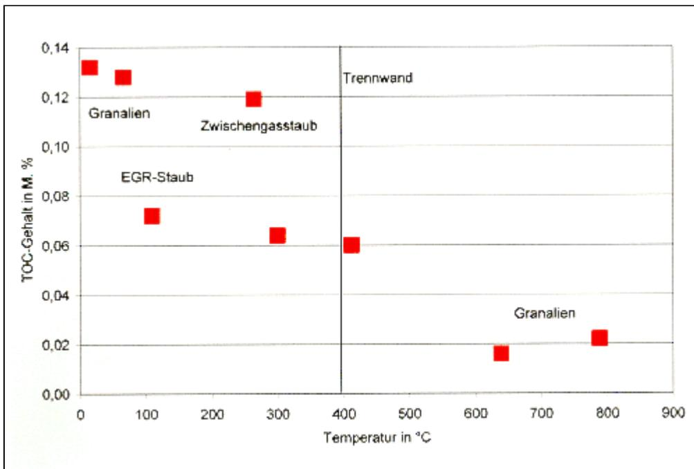
Bild 4: Abbau des Gehaltes organischer Verbindungen in den Rohstoffen in einer Ofenanlage mit Rostvorwärmer
